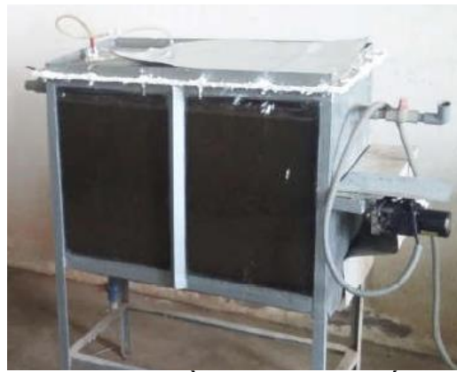
Hình 1 Mô hình lồng quay sinh học yếm khí
