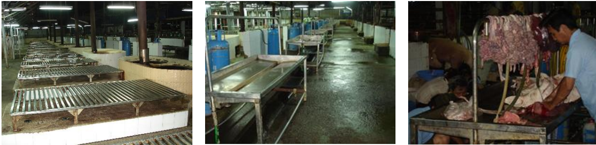
Hình 3: CSGM tập trung cải tiến (mỡ trên bệ cao 0,6 m, làm lòng trên bàn inox)
