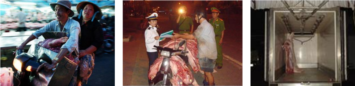
Hình 7: Vận chuyển thịt thùng có nắp (trái); không được che kín (giữa); xe bảo ôn (kín, treo và nhiệt độ mát) (phải)
