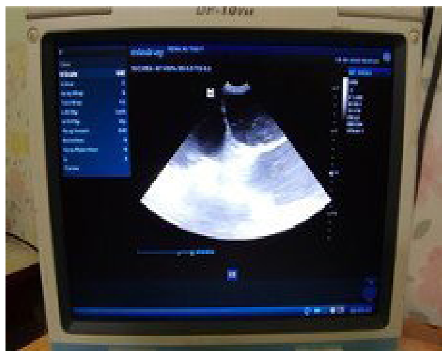
Máy siêu âm: Mindray DP-10Vet của hãng Mindray Việt Nam với đầu dò Convex (2-12 MHz)
